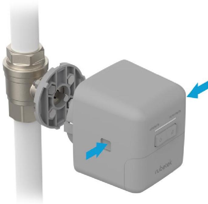
Зажмите кнопки фиксации по бокам корпуса Электропривода и установите его на крепёжный диск. Положение выемок диска должно совпадать с фиксатором на корпусе Электропривода. Отпустите кнопки и убедитесь, что Электропривод надёжно зафиксирован на кране.
